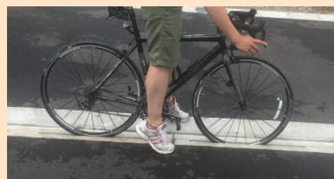
タイヤがスリットにはまり落ち込んでしまった
